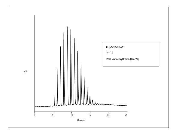
Figure 13 Analysis of PEG Monoethyl Ether (MW-550)
